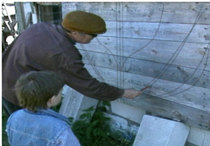
Harry Sandström seletab ressi vajalikkust ja mallide saamist.
